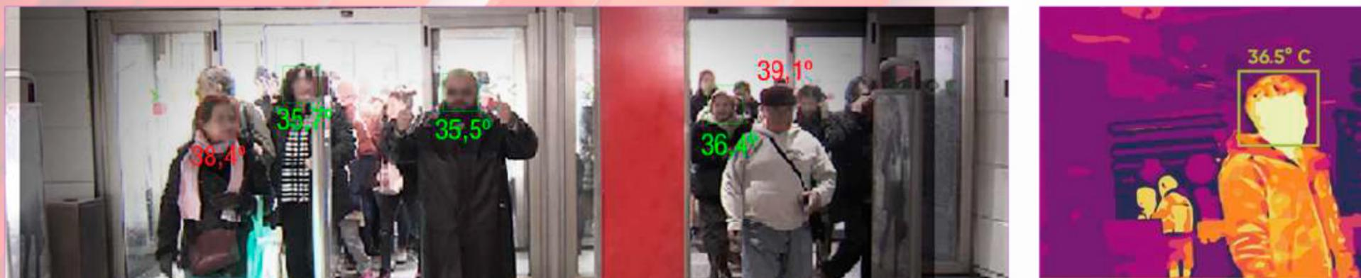
Estas cámaras termográficas poseen un algoritmo muy avanzado y potente en cuanto a medición de temperatura de alta precisión. Incorpora inteligencia artificial basada en detección facial. Esto ayuda a poder filtrar cualquier tipo de falsa alarma generado por otros emisores de calor (cigarrillos, cafés, bombillas, etc).
